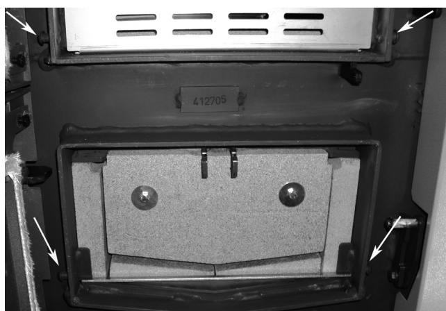
Abb. 30: Aschekasten nach vorn gezogen. Pfeile: Bolzen zur Aufhängung der Ascheauffanglade
