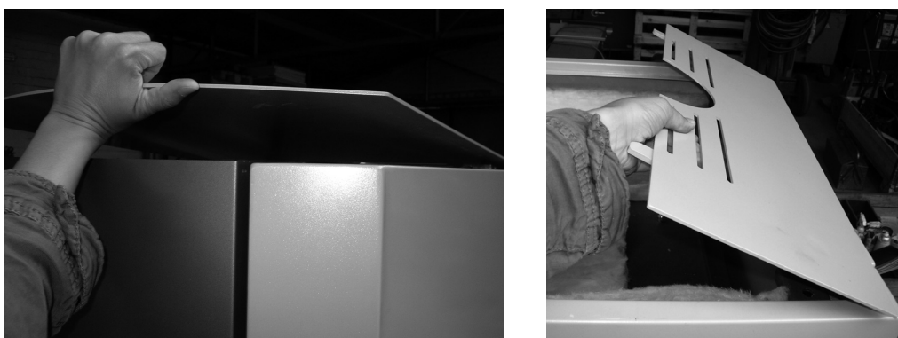
Abb. 36/37: Abnehmen der oberen Verkleidungsdeckel (vorn und hinten)
