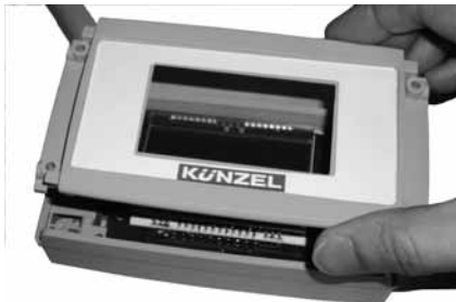
Abb. 2: Nehmen Sie die Seitenverkleidung des Gehäuses mithilfe eines kleinen Schraubenziehers o.ä. ab.
