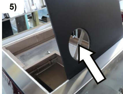
5) Nachdem Sie die restlichen 4 Schrauben gelöst haben, können Sie den Schutzring entfernen
