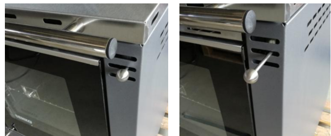
Rauchrichter (17) geschlossen Rauchrichter (17) geöffnet ⇒ die Kesselleistung wird deutlich reduziert
