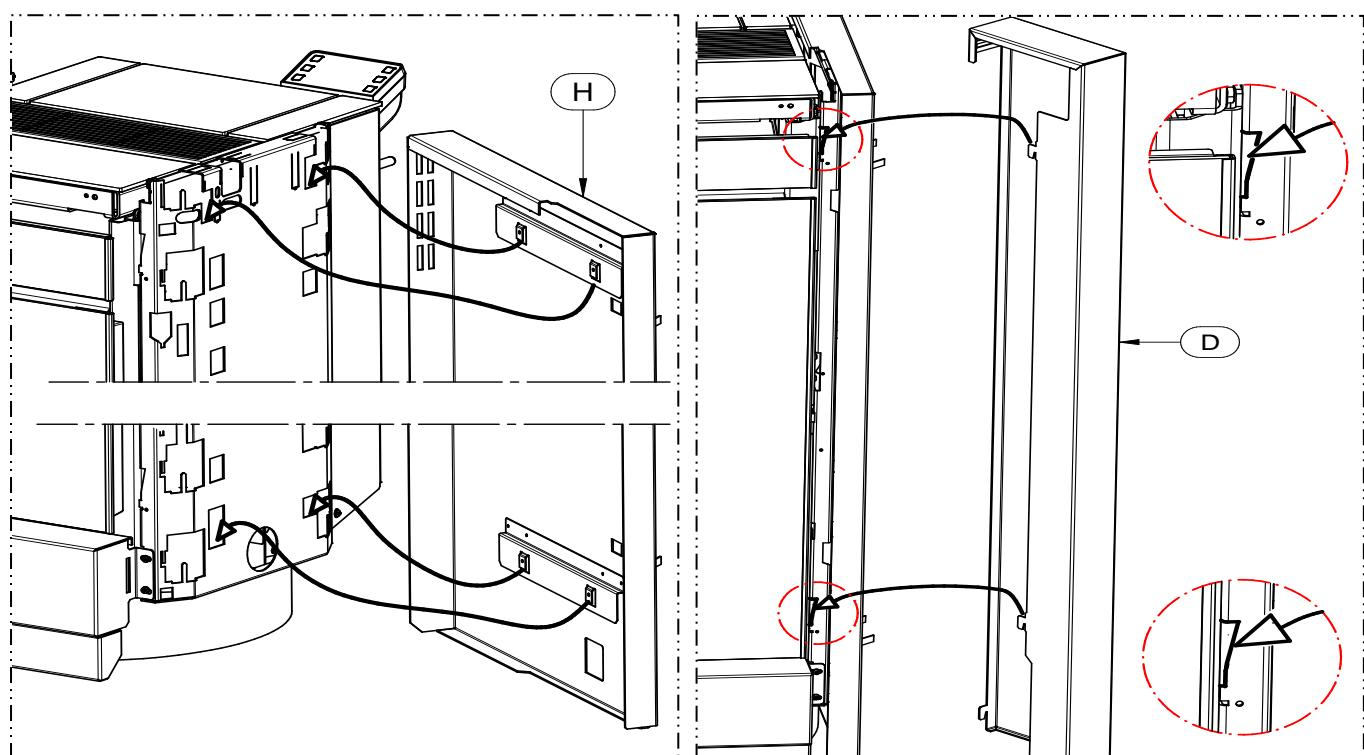
**3 – Die Seitenwand (H) montieren, indem man deren Haken in die zugehörigen Langlöcher des Geräteblechs einführt. Bei der Montage der entgegengesetzten Seitenwand (R) entsprechend vorgehen.**
