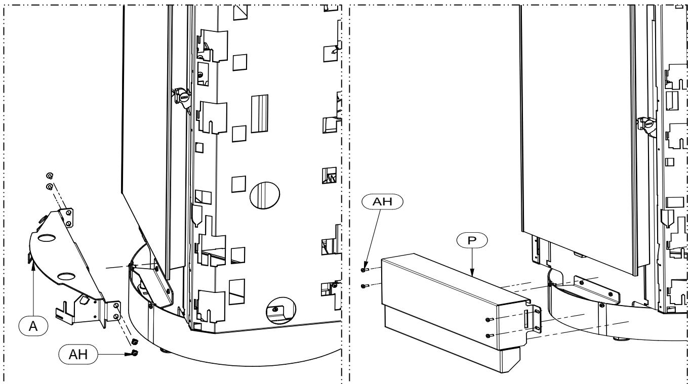
**1 – Die untere Halterung (A) ausbauen, indem man die 2 Schrauben (AH) auf der linken und rechten Seite entfernt.**
