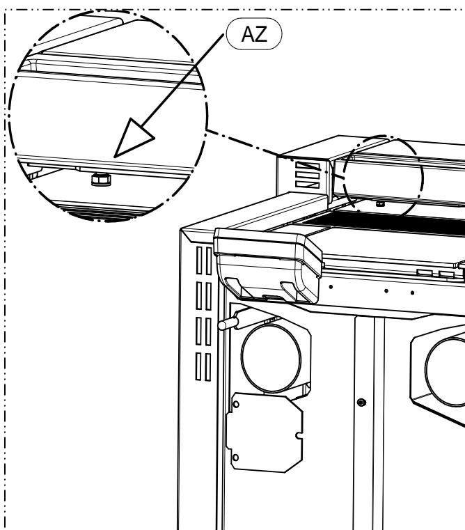
**7 – Den Fuß (AZ) so einstellen, dass das obere Profil auf die korrekte Höhe gebracht wird.**
