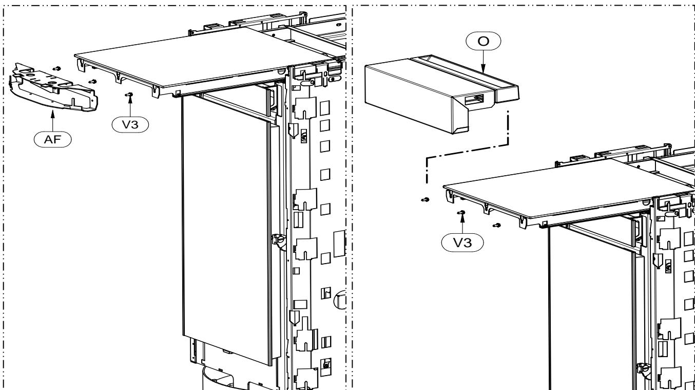
**5 – Die Ladeschale herausziehen, die 3 Schrauben (V3) ausdrehen und den Bügel (AF) entfernen.**
