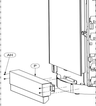
2 – Das untere Profil (P) mit den Schrauben (AH) montieren, die im Schraubenbeutel mitgeliefert wurden.
