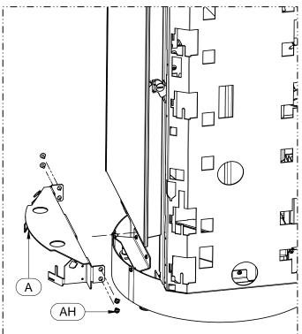
1 – Die untere Halterung (A) ausbauen, indem man die 2Schrauben (AH) auf der linken und rechten Seite entfernt.
