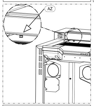
7 – Den Fuß (AZ) so einstellen, dass das obere Profil auf die korrekte Höhe gebracht wird.
