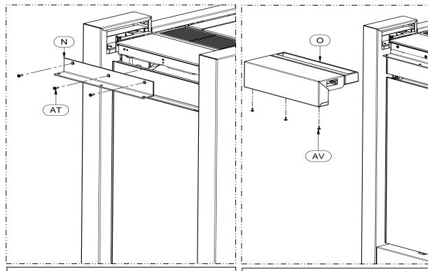
5 – Den Bügel (N) mit den 3 Schrauben (AT) aus dem Schraubenbeutel montieren.
