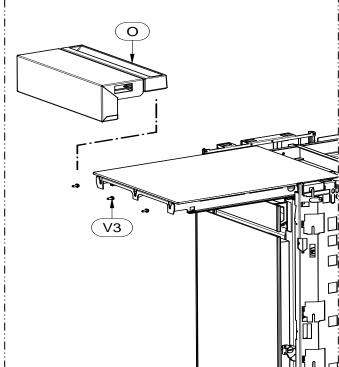
5 – Die Ladeschale herausziehen, die 3 Schrauben (V3) ausdrehen und den Bügel (AF) entfernen.
