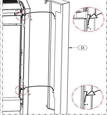
3 – Die Seitenwand (H) montieren, indem man deren Haken in die zugehörigen Langlöcher des Geräteblechs einführt. Bei der Montage der entgegengesetzten Seitenwand (R) entsprechend vorgehen.
