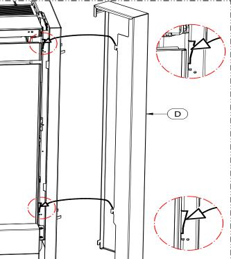
4 – Das Seitenprofil (D) montieren, indem man dessen Haken in die zugehörigen Langlöcher des Geräteblechs einführt. Bei der Montage des entgegengesetzten Seitenprofils entsprechend vorgehen.
