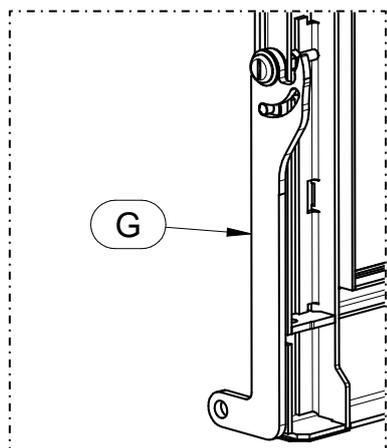
Ermöglicht das Öffnen der Tür zum Nachladen von Brennstoff. Weiteres Holz darf erst dann nachgelegt werden, wenn das vorherige Holz aufgebrannt oder zu Glut geworden ist. Die Befuerungstür des Feuerraums langsam öffnen, und die Holzscheite geordnet auf das Glutbett legen. Zum Abschluss die Tür langsam schließen.
