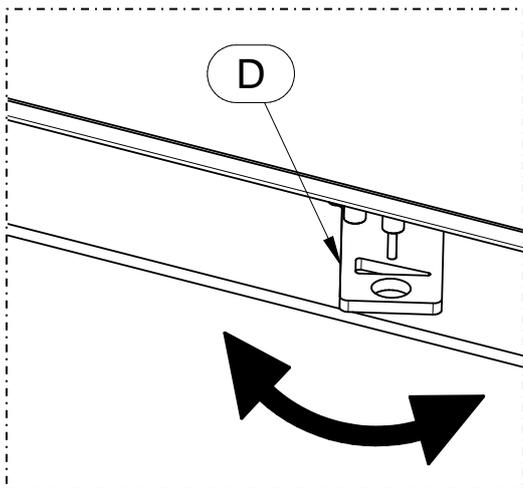
Mit ihm wird der Primärluftzustrom geregelt. Indem sie den Rost des Feuerraums durchströmt, speist die Primärluft die Verbrennung und bestimmt dabei deren Leistung und Geschwindigkeit. Wird der Hebel nach links versetzt, erhöht sich der Luftzustrom. Verschiebt man den Regler hingegen nach rechts, wird der Luftzustrom vermindert.
