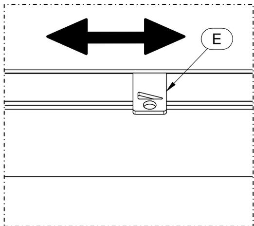
Sie regeln den Zustrom der Sekundärluft, die die Aufgabe hat, über die Glasscheibe zu strömen und sie so sauber zu halten. Wird der Hebel nach links versetzt, erhöht sich der Luftzustrom. Verschiebt man ihn hingegen nach rechts, wird der Luftzustrom vermindert.
