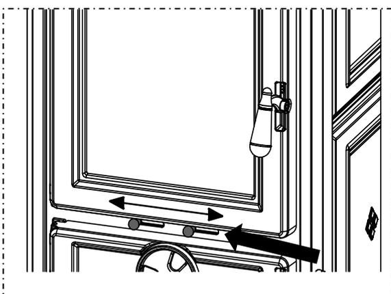
Sie regeln den Zustrom der Sekundärluft, die die Löcher im rückwärtigen Teil der Brennkammer durchströmt, dabei vorgeheizt wird und so die Zündung der zweiten Verbrennung unterstützt. Wird einer der beiden Hebel nach links umgelegt, verringert sich der Luftzustrom. Verschiebt man ihn hingegen nach rechts, wird mehr Luft zugeführt.
