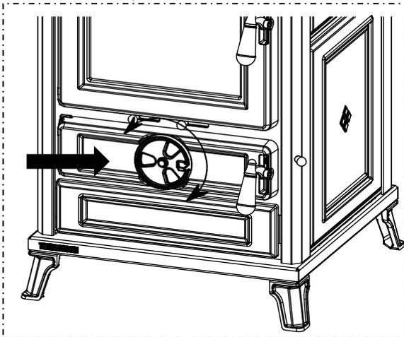
Mit ihm wird der Primärluftzustrom geregelt. Indem sie den Rost des Feuerraums durchströmt, speist die Primärluft die Verbrennung und bestimmt dabei deren Leistung und Geschwindigkeit. Dreht man den Regler entgegen dem Uhrzeigersinn, wird der Luftzustrom vermindert. Dreht man den Regler im Uhrzeigersinn, erhöht sich der Luftzustrom.
