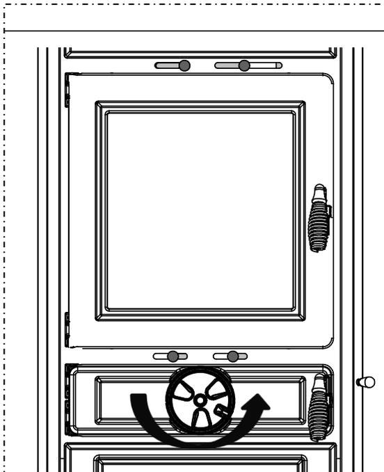
Es handelt sich um ein Gerät mit intermittierender Verbrennung, das durch das Nachlegen von Holz gespeist werden muss. Wenn in der Brennkammer Glut vorhanden, die Verbrennung also in vollem Gange ist, wird wie folgt die erste Befüllung vorgenommen:
