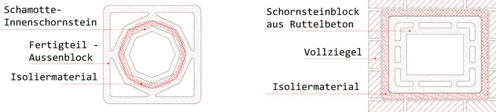
Um mit unseren Herden die besten Ergebnisse zu erzielen, empfehlen wir Schornsteine mit rundem Querschnitt, glatten Innenwänden und über die gesamte Länge konstantem Querschnitt.
