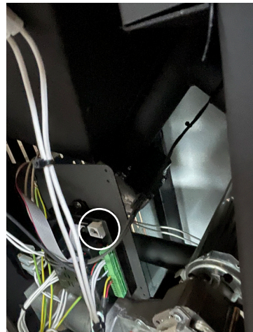
Hauptplatine mit RS232 Schnittstelle für WLAN-Modul
