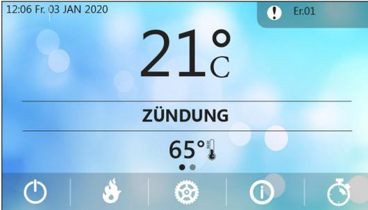
Eine Fehlermeldung wird mit einem **!** und dem zugehörigen Fehler-Code angezeigt. Durch Drücken auf den Fehler-Code, öffnet sich das Fehlerfenster.
