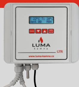
Der Steuergerät ermöglicht die Regelung der Lüfter Drehzahl im manuellen oder vollautomatischen Modus. Im Automatikmodus wird die Drehzahl entsprechend der Temperatur der Wärmetauscher Schale geregelt.
