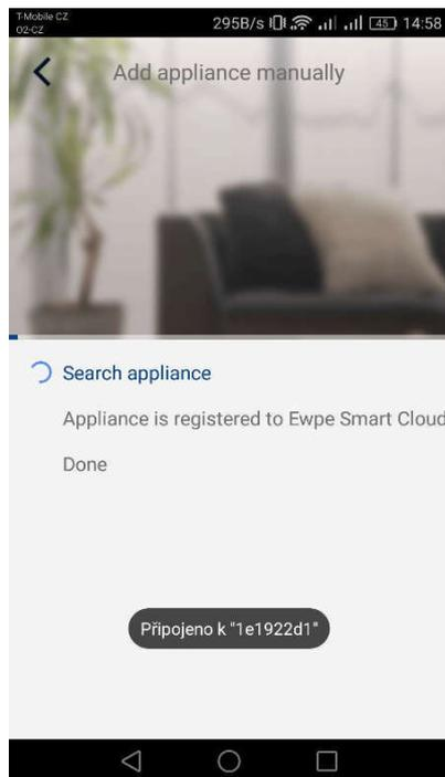
Bei erfolgreichem Pairing erscheint die folgende Meldung. Durch Drücken der Taste „OK“ wechseln Sie zum Home-Bildschirm zurück, und nun können Sie das Gerät bedienen. Es wird noch empfohlen, die Anwendung „EWPE Smart“ neuzustarten.
