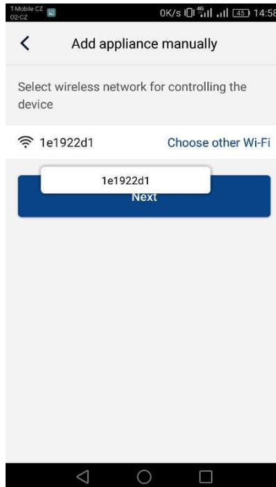
6. Geben Sie im nächsten Schritt das Wi-Fi-Netzwerk ein, mit dem Sie das Gerät verbinden wollen. Geben Sie auch das Passwort ein, und drücken Sie die Taste „Submit“, um fortzufahren.
