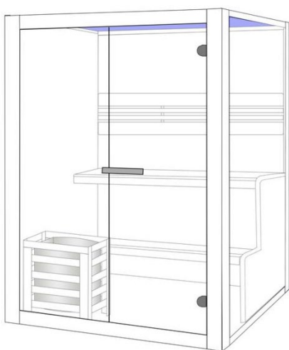
(14) položite krovni panel na montirane panele
