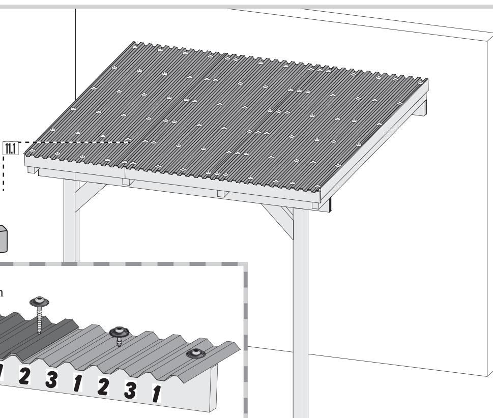
Die Platten sind in jedem 3. Wellenboden zu verschrauben. In den äußereren Randfeldern jedoch in jedem Wellenboden sowie in der Überlappung. Schrauben Sie bis die Gummidichtung fest an der Platte liegt. Die Löcher in den Dachplatten werden in der Mitte der Welle mit einem Holzbohrer gebohrt. Bitte beachten Sie, dass das Bohrfutter die Dachplatte nicht beschädigt. Die Schrauben müssen rechtwinklig in die Latten montiert werden.
