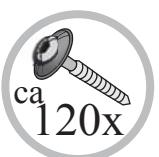
Die Platten sind in jedem 3. Wellenboden zu verschrauben. In den äußeren Randfeldern jedoch in jedem Wellenboden sowie in der Überlappung. Schrauben Sie bis die Gummidichtung fest an der Platte liegt. Die Löcher in den Dachplatten werden in der Mitte der Welle mit einem Holzbohrer gebohrt. Bitte beachten Sie, dass das Bohrfutter die Dachplatte nicht beschädigt. Die Schrauben müssen rechtwinklig in die Latten montiert werden.
