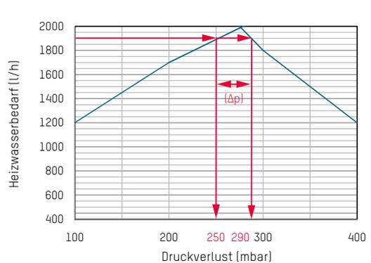
**BEISPIEL ZUR INTERPRETATION DER DURCHFLUSS- UND DRUCKVERLUST-DIAGRAMME**
