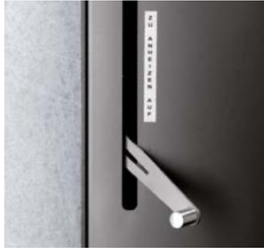
Um nach dem Anheizen möglichst schnell die optimale Brennraumtemperatur zu erreichen, wird die Anheizklappe geöffnet. Die Abgase strömen ohne großen Widerstand an dem Wärmetauscher vorbei. Dadurch entsteht ein höherer Zug und somit eine stärkere Sauerstoffzufuhr. Wenn nach einigen Minuten die Anheizklappe wieder geschlossen wird, entfaltet sich der volle Wirkungsgrad des Kaminofens.
