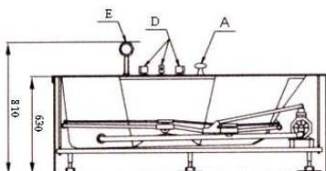
A elektronisches Controlpanel
