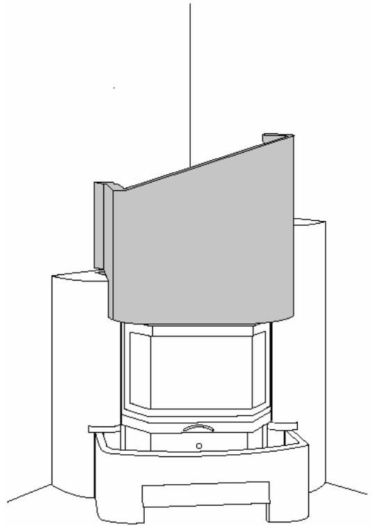
**Abbildung 5: Montage der Kaminhaube Oberteil, der Abdeckung (siehe Maße zur Anbringung der Dübel und Schrauben als Auflager) sowie des Luftgitter**
