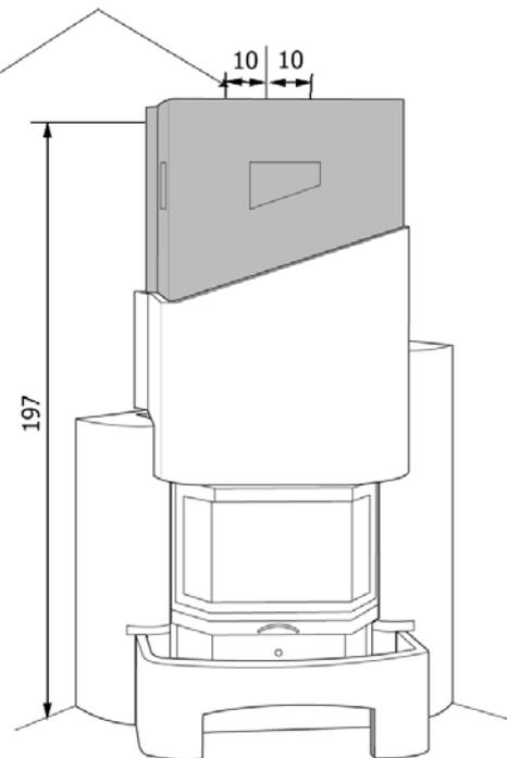
**Abbildung 6: Montage der Dekorelemente**
