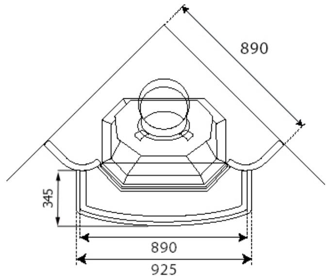
**Abbildung 8: Abmessungen**
