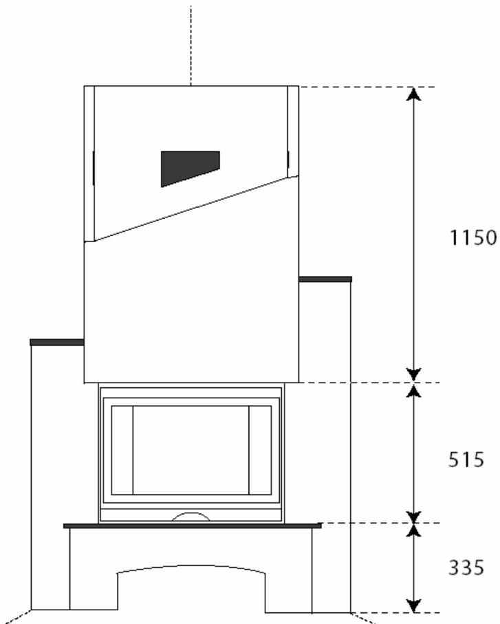
**Abbildung 7: Abmessungen**
