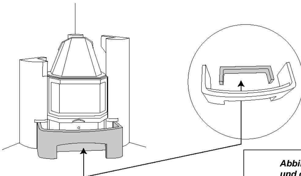
**Abbildung 3: Montage des Sockel und der Sockelblende**
