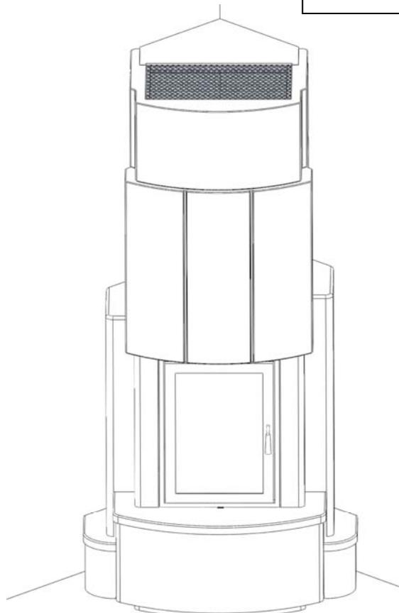
**Abbildung 10: Montage des Luftgitter**
