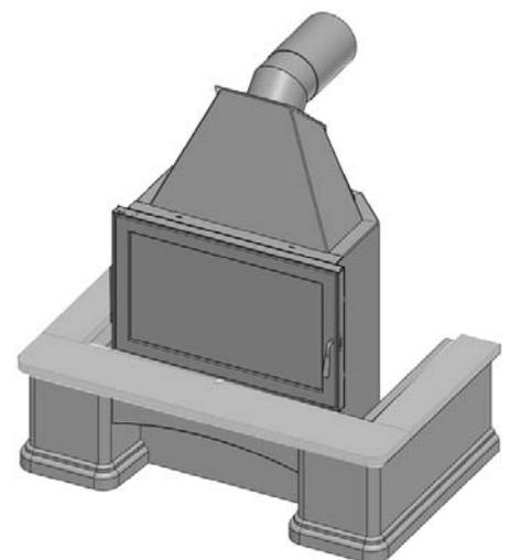
**Abbildung 4: Montage der Sockelplatten**
