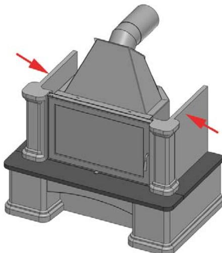
**Abbildung 5: Montage der Seitenelemente**
