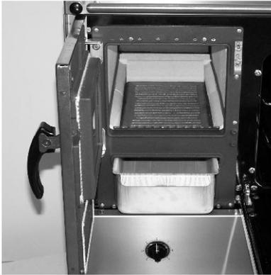
Wenn Sie den Knopf auf der Feuerungsseite des Gerätes betätigen, verschieben Sie den innenliegenden Rüttelrost. Dadurch können Sie die im Brennraum befindliche Asche, staubfrei in den darunter liegenden Aschekasten abrütteln.
