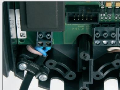
Zugentlastungen für alle Leitungen. Leichter elektrischer Anschluss durch steckbare Klemmen
