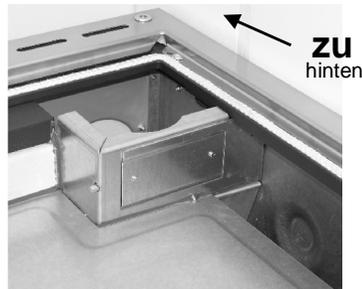
Wenn Sie den Knopf auf der Backofenseite des Gerätes betätigen, verkürzen Sie den Heizgasweg und ermöglichen dadurch einen besseren Durchzug. Zum Öffnen der Klappe ziehen Sie den Bedienungsknopf ganz nach vorne (auf). Zum schließen schieben Sie den Bedienungsknopf ganz nach hinten (zu).
