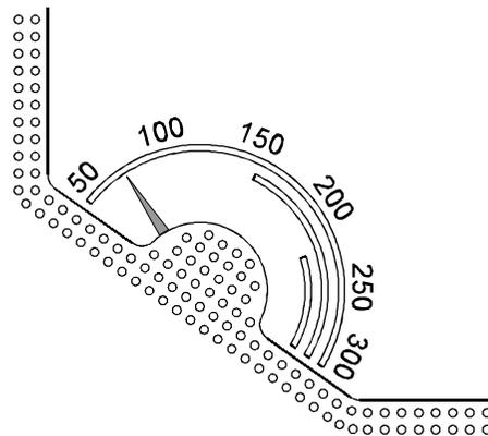
Das Thermometer im Backofenfenster zeigt Ihnen die aktuelle Temperatur im Backofen mit einer geringfügigen Toleranz an.
