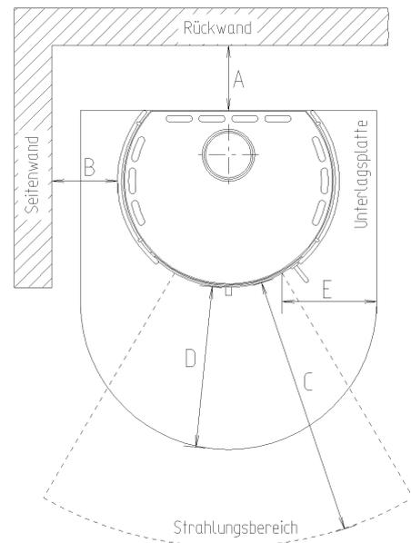
Bodenschutzplatten (Unterlegplatten bzw. U-Platten) führen wir in unserem Zubehörprogramm. Sie können diese im Bedarfsfall bei Ihrem Ofenfachhändler bestellen.
