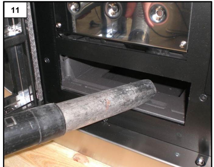
Nach dem Entfernen des Aschenkastens den darunter liegenden Bereich (Abb. 10) entnehmen und die darin vorhandenen Rückstände (Abb. 11) mit einem geeigneten Aschesauger absaugen. Den Boden und den Aschekasten wieder einführen.
