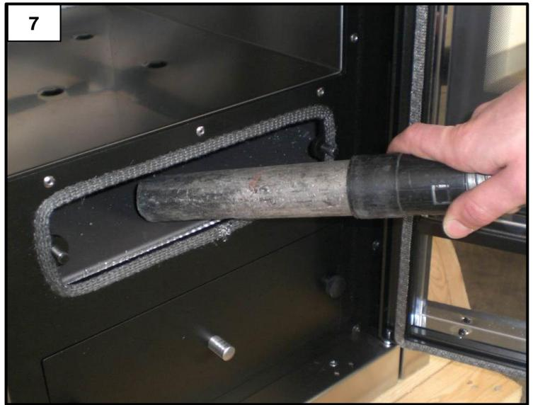
Den Stützen unter dem Ofen (Abb. 6) entfernen und die Ascheablagerungen unterhalb und seitlich des Ofens (Abb. 7) absaugen. Den Stützen nach der Reinigung wieder anbringen und dabei darauf achten, dass die Rauchdichtheit gegeben ist.
