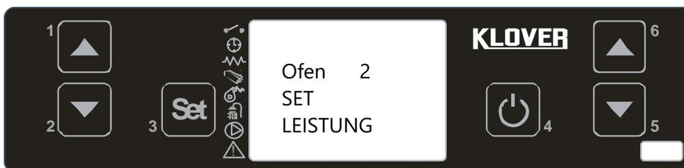
Wird eine der drei OFENLEISTUNGEN festgelegt, übergeht der Heizungsherd die Funktion des Raumthermostats (bzw. jedes angeschlossenen Thermostats) und schaltet in die Modulationsfunktion. Das System schaltet sich erst wieder aus, wenn die in SET OFEN eingestellte Temperatur erreicht ist.
