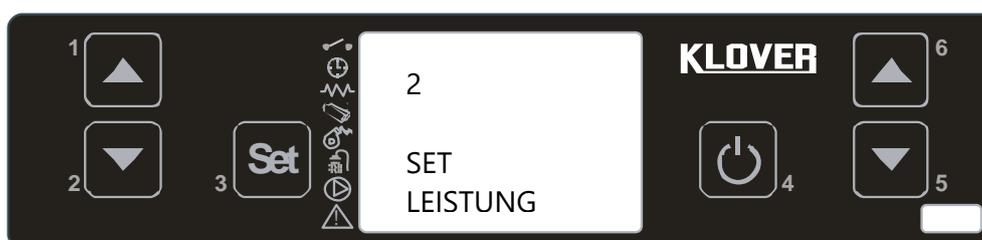
Es ist möglich, eine der fünf Betriebsleistungen („1“, „2“, „3“, „4“, „5“) (siehe „[Betriebsphase von Leistung 1 bis Leistung 5](#)“), die Leistung Brauchwasser („[B.WASSER](#)“) (siehe „[Betriebsphase mit Leistung Brauchwasser](#)“) oder eine der drei Ofen-Leistungen („Ofen 1“, „Ofen 2“ und „Ofen 3“) (siehe „[Betriebsphase mit Leistung Ofen/Herdplatte](#)“) einzustellen. Nach dem Einstellen des gewünschten Werts den Vorgang mit der Taste 4 bestätigen oder einige Sekunden warten.
