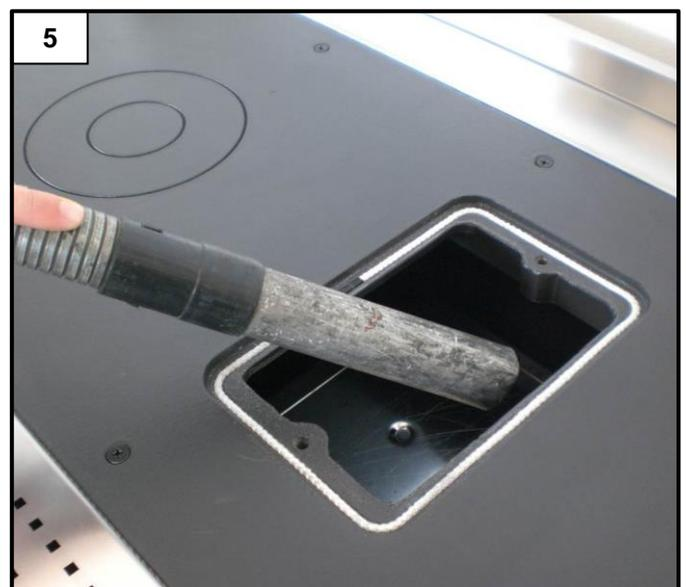
Den Stützen an der Herdplatte (Abb. 4) entfernen und die Ascheablagerungen im Bereich oberhalb des Herds (Abb. 5) absaugen. Den Stützen nach der Reinigung wieder anbringen und dabei darauf achten, dass die Rauchdichtheit gegeben ist.
