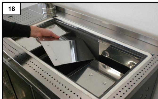
Das Rauchleitblech entfernen, das sich zwischen der Brennkammer und dem Ofen befindet (Abb. 17 und 18).
