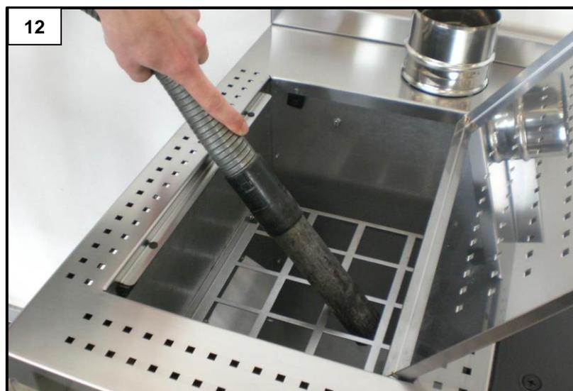
Für einen einwandfreien Betrieb sind die Sägemehlablagerungen auf dem Boden des Behälters (Abb. 12) mindestens alle 15 Tage abzusaugen. **Den Pelletbehälter nach jeder Heizsaison komplett entleeren.**
