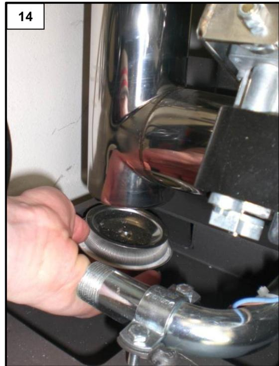
Nachdem man das linke Seitenteil entfernt hat (Abb. 13), die Kappe des hinteren T-Stücks abnehmen (Abb. 14) und das gesamte Rauchabzugsrohr innen mit einer Bürste reinigen. Dabei etwaige Rußablagerungen absaugen. Die Kappe nach der Reinigung wieder anbringen und dabei darauf achten, dass die Rauchdichtheit gegeben ist. Das hintere T-Stück ist nur an Modellen mit oberem Rauchabzug vorhanden.
